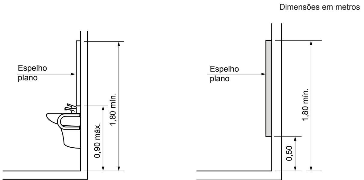
**Figura 122 – Altura de instalação do espelho – Vista lateral**
