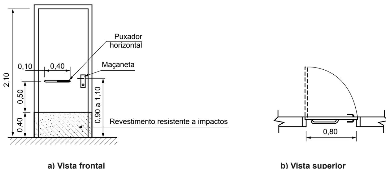
**Figura 84 – Portas com revestimento e puxador horizontal**
