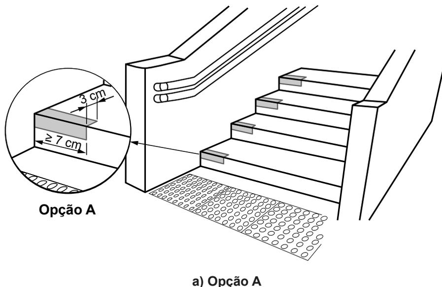
Dimensões em centímetros
