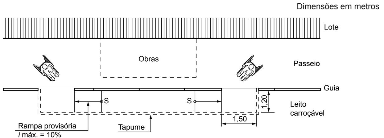
Figura 90 – Rampas de acesso provisórias – Vista superior
