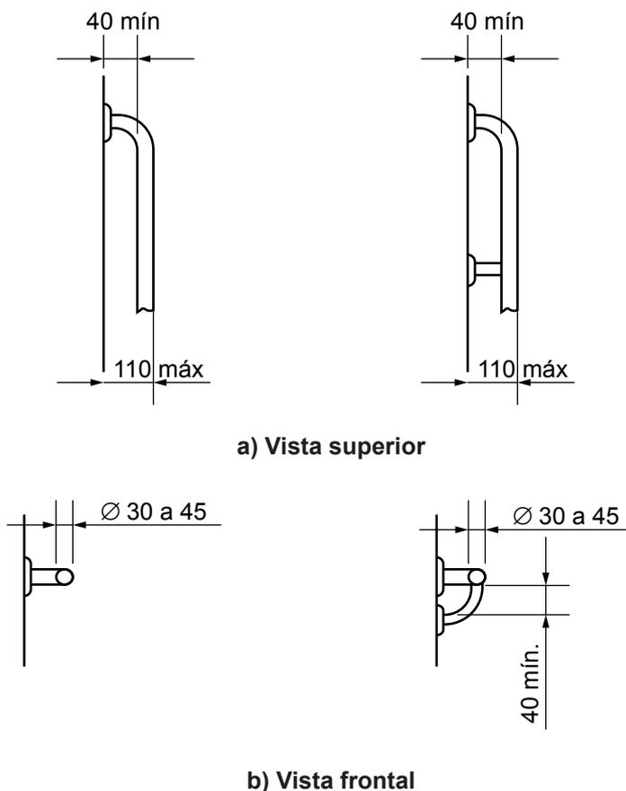
**Figura 101 – Dimensões das barras de apoio**
