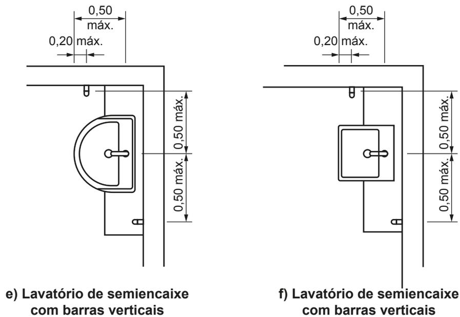
Figura 113 – Barra de apoio no lavatório – Vista superior
