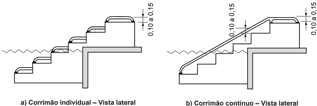
**Figura 150 – Escada submersa – Corrimão individual e contínuo**
