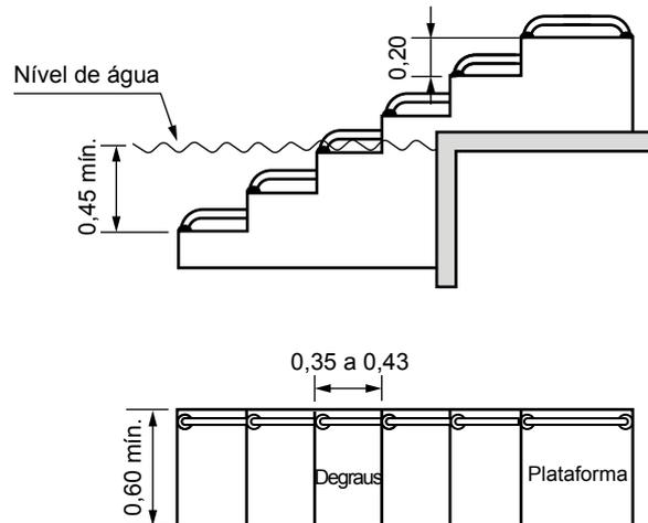
Figura 149 – Escada submersa – Exemplo – Vistas lateral e superior
