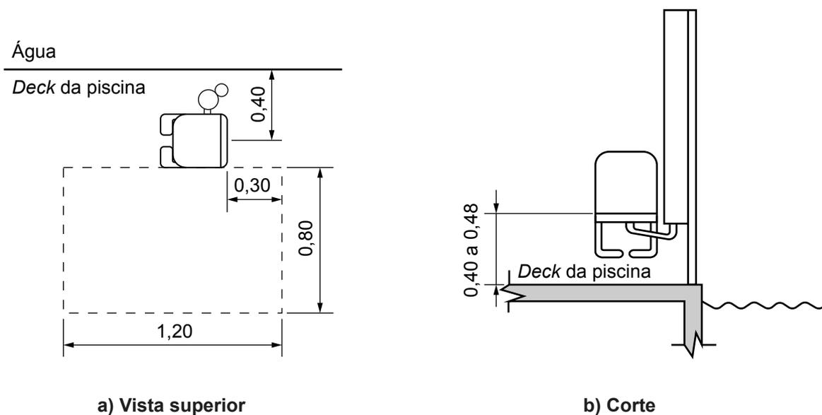
**Figura 151 – Equipamento de transferência para a piscina**
