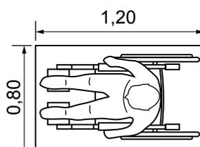
Figura 3 – Dimensões do módulo de referência (M.R.)
